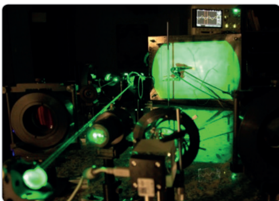
Obrázek 1: Měření akustické přenosové ztráty průchodu zvuku skrz aktivní plošný akustický metamateriál pomocí nově vyvinuté metody založené na digitální holografické interferometrii.
