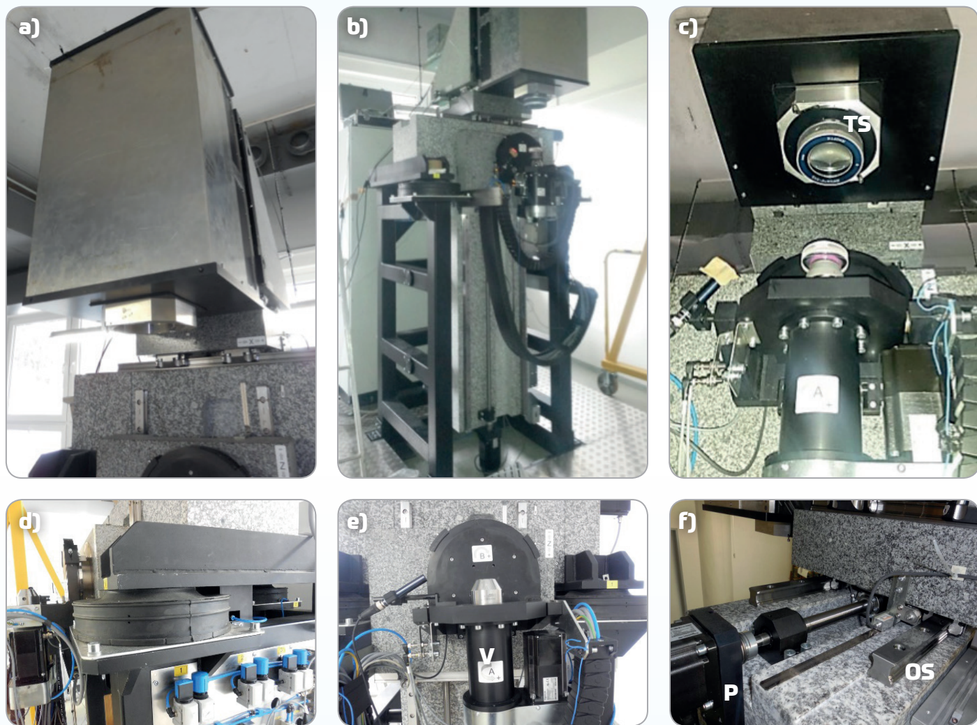
Obrázek 1: Asférický interferometr bez krytu: a) detailní pohled na měřicí jednotku; b) celkový pohled na měřidlo; c) detailní pohled na uchycený měřený element a transmisní sféru (TS); d) pasivní tlumení vibrací; e) hydroexpanzní vřeteno (V) s podtlakem; f) pohon (P) se šroubem a odměřovacím systémem (OS).
