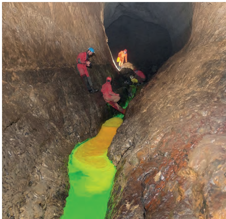
Vědci v terénu provedli experiment pomocí fluoresceinu, který se používá na určení tras a dynamiky podzemních toků. Získané informace je možné využít pro plánování dalšího postupu průzkumu.
